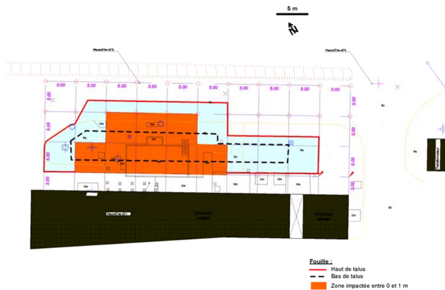
Figure 3 : Zone impactée entre 0 et 1 m de profondeur
