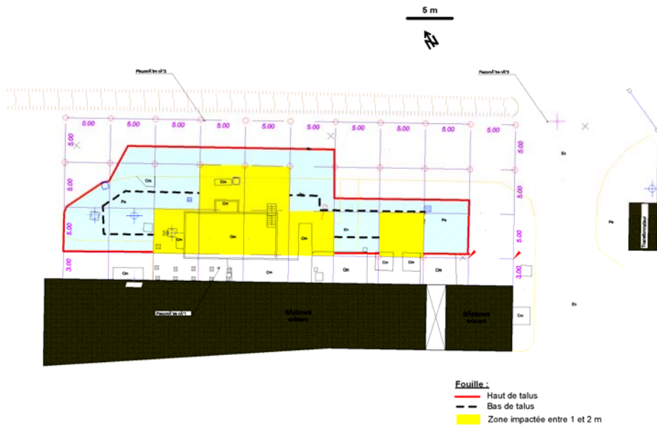
Figure 4 : Zone impactée entre 1 et 2 m de profondeur
